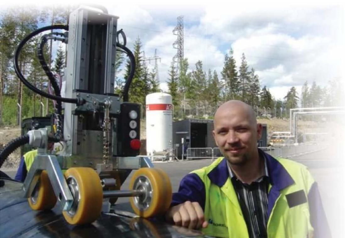
Тестовое оборудование испытания прочности на отрыв при применении на трассе
